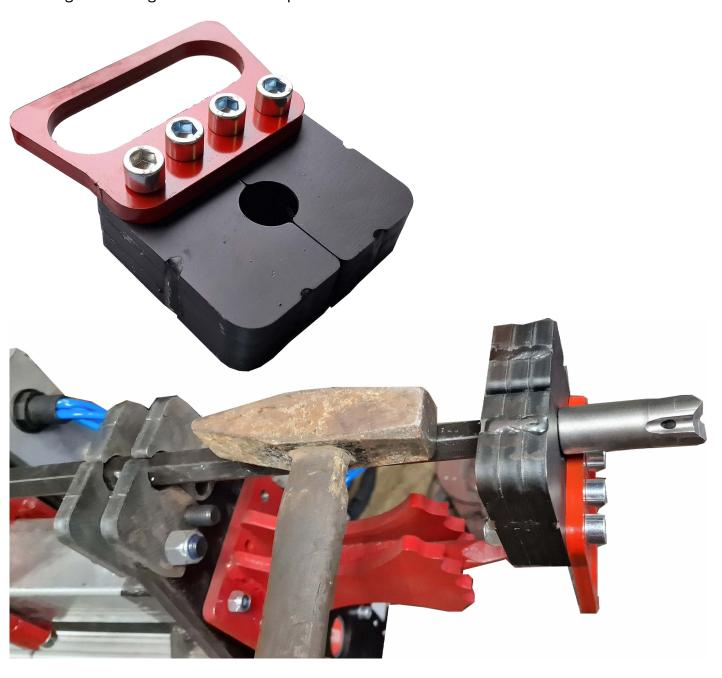
Abschlagvorrichtung von Konusbohrköpfen mit dem Hammer oder mit dem Eigengewicht. Klaue öffnene und über die Bohrstange führen.
